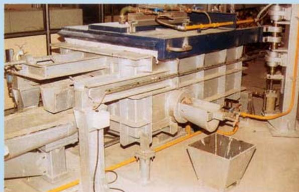
Insérée entre nos fours basculants de maintien et la tête de chaîne, une boîte filtre d'un type particulier assure, tout en filtrant le métal, un basculement automatique du four, d'où un débit régulier de métal.
