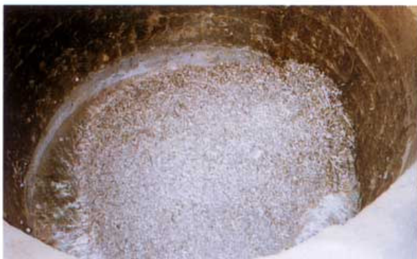
◀ Effet VORTEX par pompe PEM 800 Débit : 12 tonnes par minute
