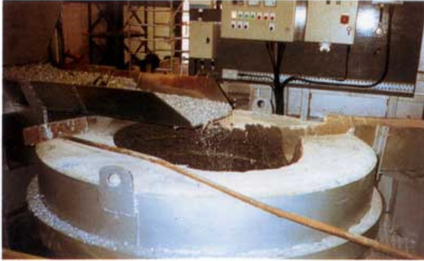
▲ Alimentation du creuset de fusion
