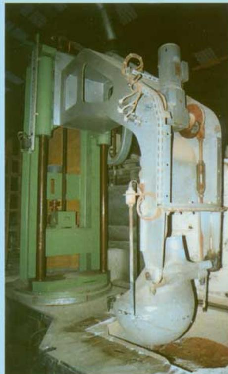
Ce système peut être équipé d'une gestion automatique permettant de comptabiliser le poids de métal puisé, et de gérer la production du four.
