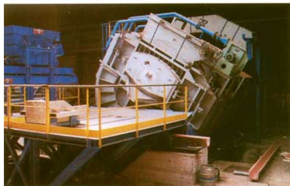
▲ Skip, Trémie et chargement automatique du four - par tapis à bande
